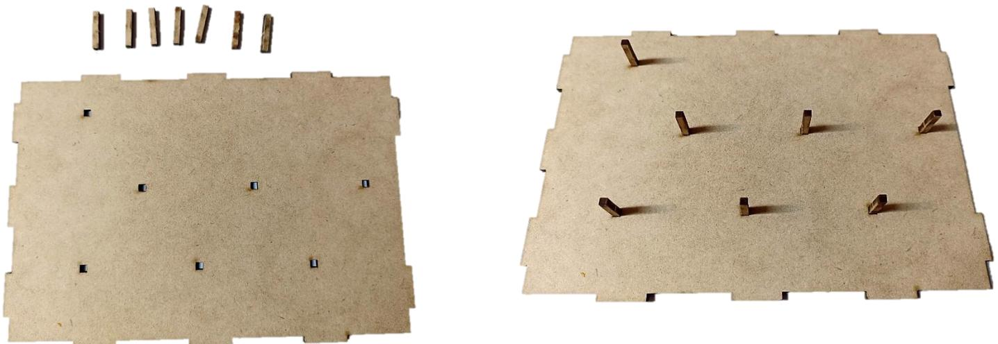
Tomamos la pieza que ya abiamos pegado anteriormente entre el engrane el circulo de 6mm y el circulo numerado, lo colocamos como se muestra en la imagen
